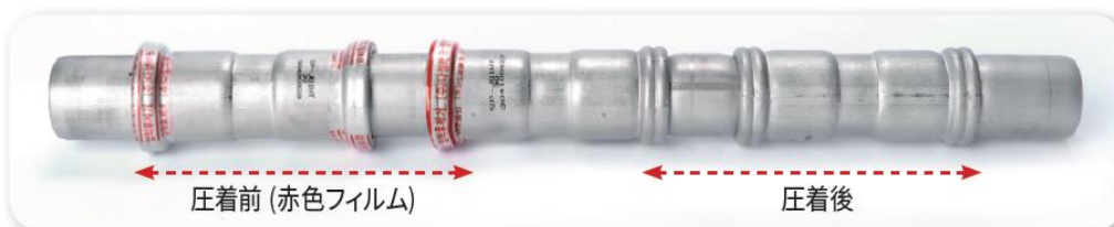
圧着完了後、フィルムを除去する。
